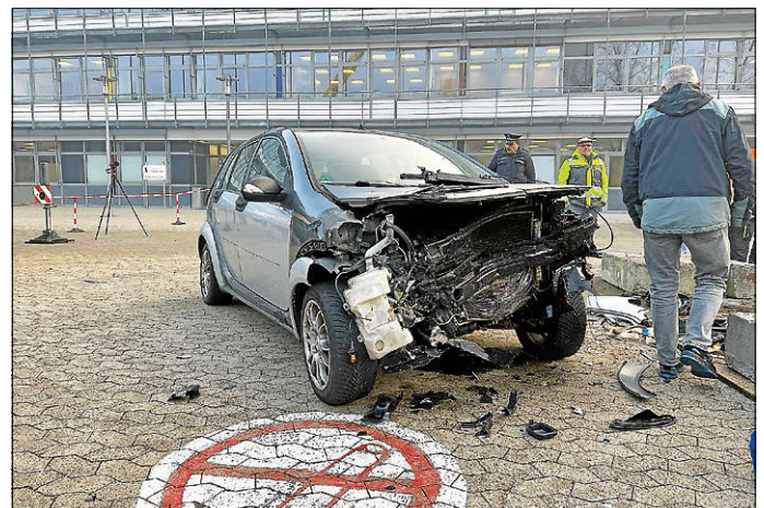
Direkt zum Start der Verkehrssicherheitstage wird ein Fahrzeug aus neun Metern Höhe auf einen Baumstamm abgeworfen. Das Ergebnis zeigt, welche Kräfte bei einem Aufprall wirken und welcher immense Schaden selbst bei niedriger Geschwindigkeit entstehen kann.
